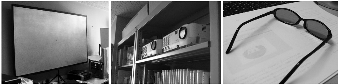
図2 シルバースクリーン（左）と偏光フィルタを取り付けたプロジェクタ（中央）及び受講生用偏光眼鏡（右）
